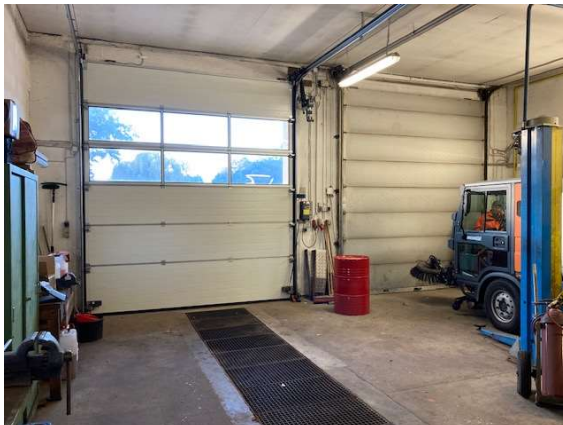
Fahrzeughalle mit Montagegrube und Sektionaltoren
