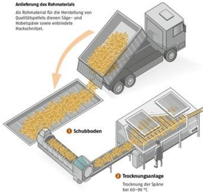
Abbildung 5: Pelletieranlage – Anlieferung und Trocknungsanlage (modifiziert) (Quelle: Deutsches Pelletinstitut)<sup>46</sup>
