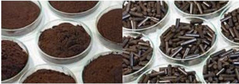
**Abbildung 9: Produkt einer HTC-Anlage, lose und pelletiert (Quelle: SunCoal Industries)<sup>51</sup>**
