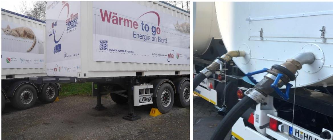
**Abbildung 14: Latentwärmespeicher**
