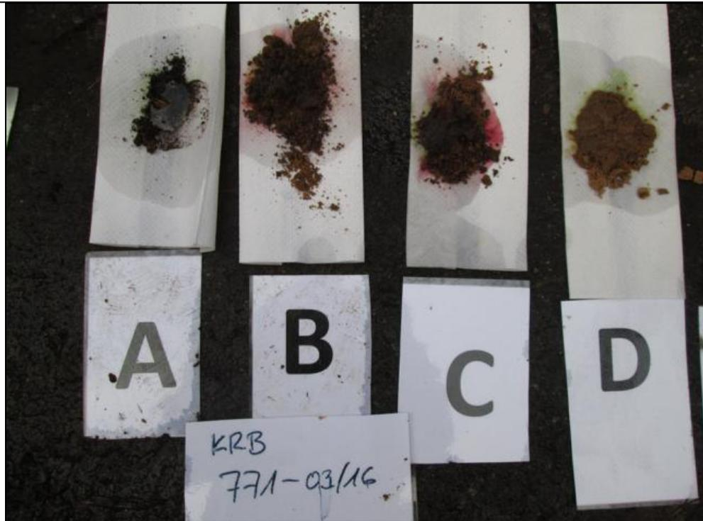
**Bild :** Forst Dragahn, Fläche 771, TNT- Schnelltest
