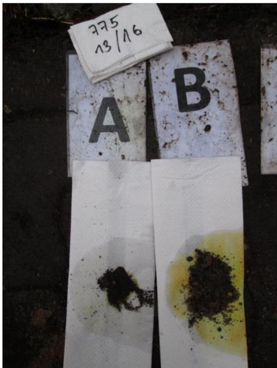
**Bild :** Forst Dragahn, Fläche 775, TNT- Schnelltest Probe 13/16 A-B
