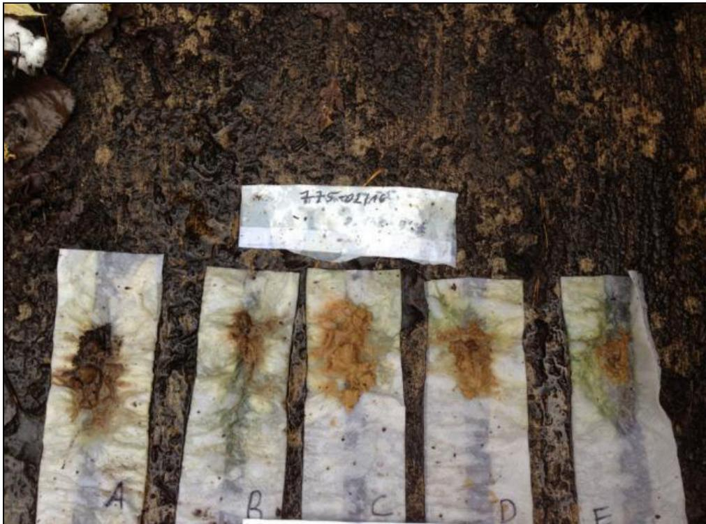
**Bild :** Forst Dragahn, Fläche 775, TNT- Schnelltest
