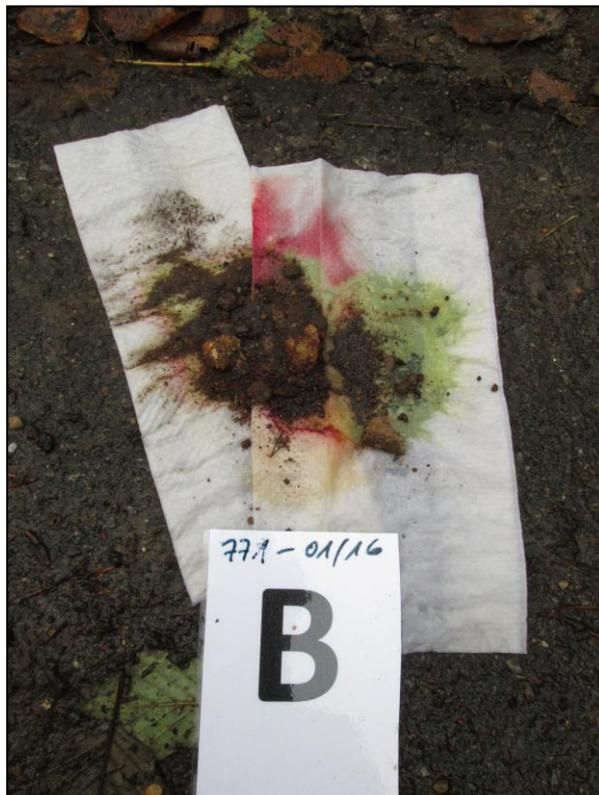
**Bild :** Forst Dragahn, Fläche 771, TNT- Schnelltest
