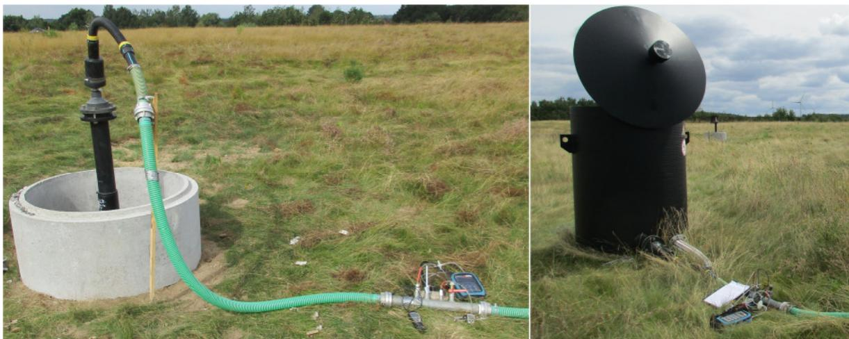
**Abb. 3.9:** Anschluss temporäre Gasleitung zum Absaug- und Belüftungsversuch am Messpegel (links) und am Gasbrunnen (rechts)
